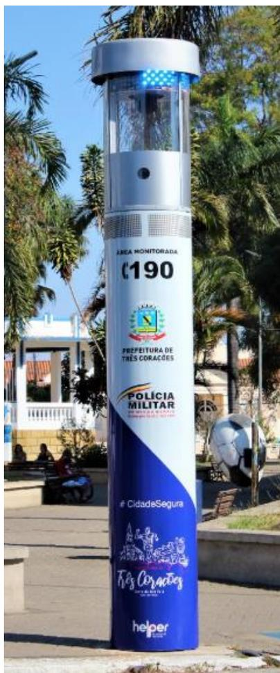
Estrutura de 4 metros em aço galvanizado, resistente a projétil de baixo calibre;
